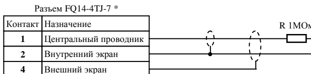
Рисунок 1. Электрическая схема чувствительного кабеля (ЧЭ).
