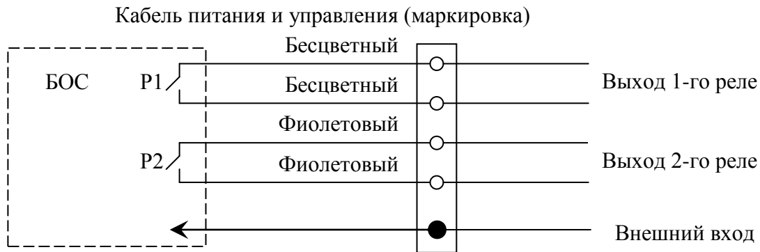
Рис. 8.6. Подключение выходных реле. Контакты реле в положении «тревога».
